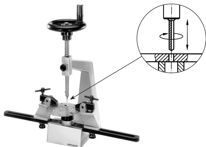
2. Enlever la pointe à centrer No 6. Introduire un alésoir correspondant au diamètre du bouchon à remplacer. Tourner lentement le volant. Soulever de temps en temps la broche pour dégager les copeaux.
