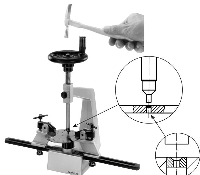
3. Enlever l'alésoir et fixer à la place un pousoir correspondant à un diamètre légèrement plus grand que celui du bouchon à chasser. Appuyer avec une main sur le volant pour supprimer l'effet du ressort. Procéder au chassage en frappant avec un marteau de préférence en laiton.
